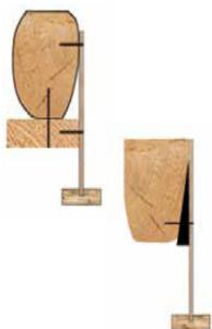
**Chevron arrondi:** souvent les chevrons sont arrondis dans les anciennes charpentes. Fixez sous le chevron une planche et sur le côté la Poutre en T
